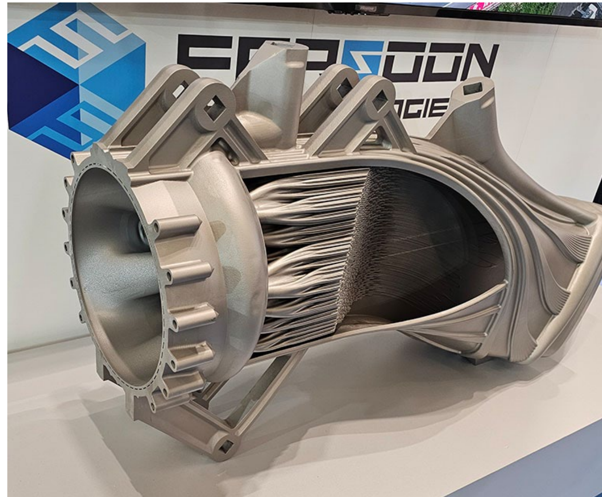
Osa: Hypersonic Precooler, Valmistaja: Farsoon Materiaali: 316l, Laite: FS811M-U-8
