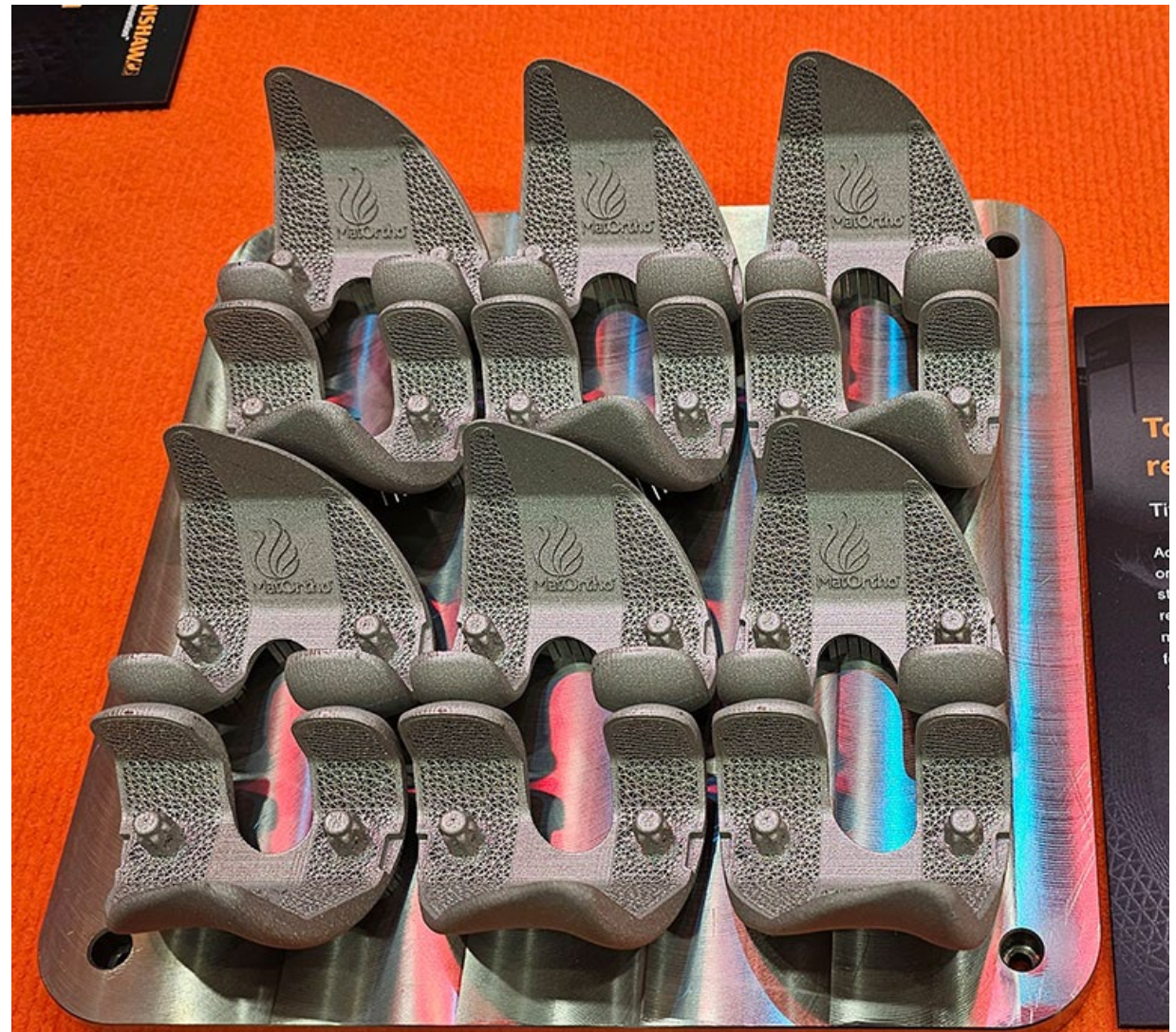
Osa: Total knee replacement (TKR) Materiaali: Titaani Ti64Al4V
