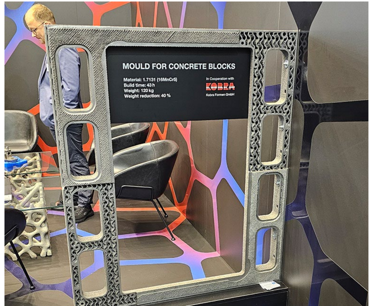
Mould for concrete blocks Materiaali: 1.7131 Tulostusaika: 43 h, paino 120 kg
