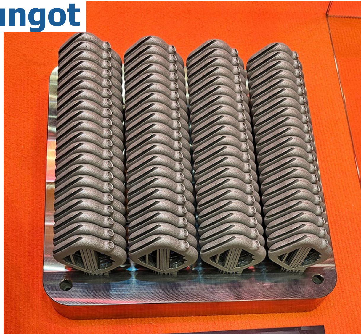
Kellorungot, sarjatuotanto-osa, Materiaali: Titaani, Ti64Al4V
