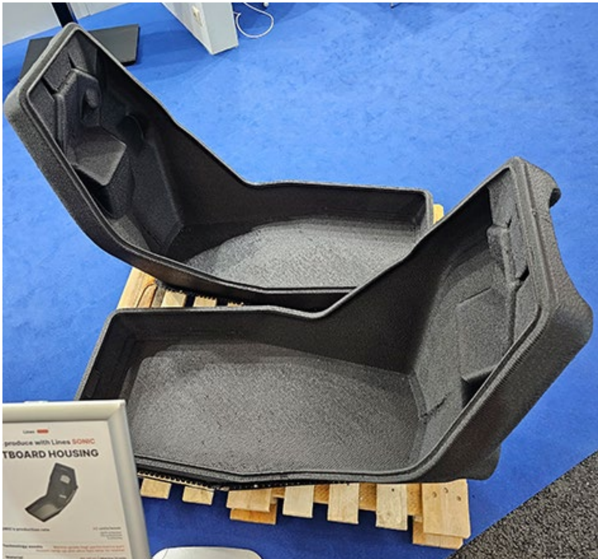
Perämootorin kotelo, 40 kpl / viikko (Materiaali: PP GF30)
