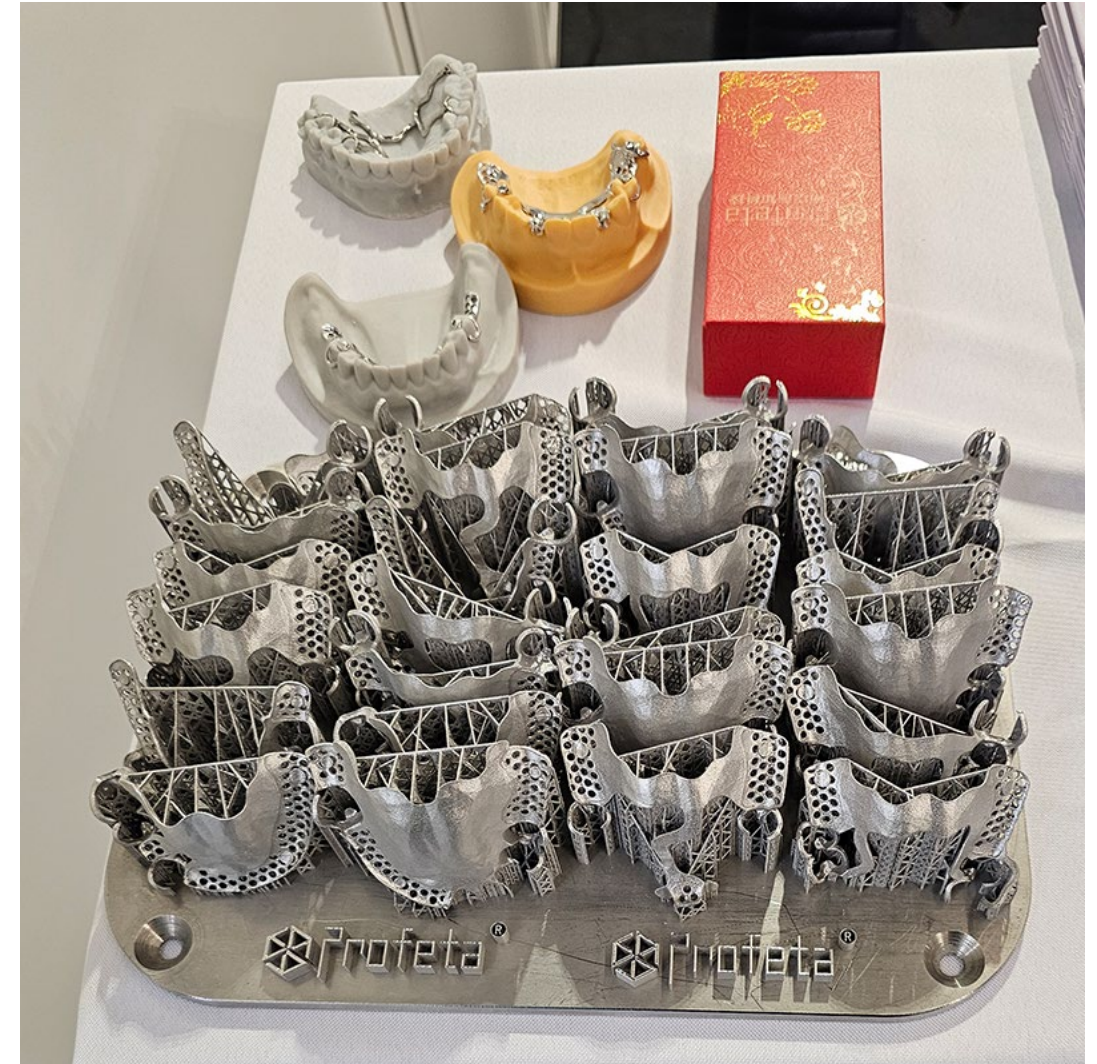
Hammasproteesin osia. Menetelmä: PBF, materiaali: CoCr. Valmistaja: Profeta
