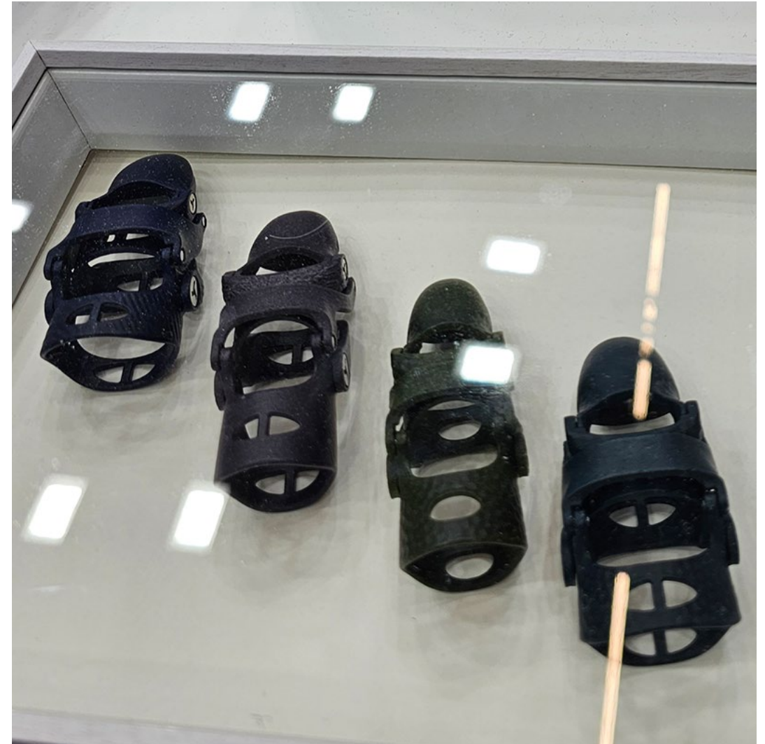
Body-powered Partial-hand prostheses. Menetelmä: HP MJF, Materiaali: PA12, Valmistaja: Naked Prosthetics / HP
