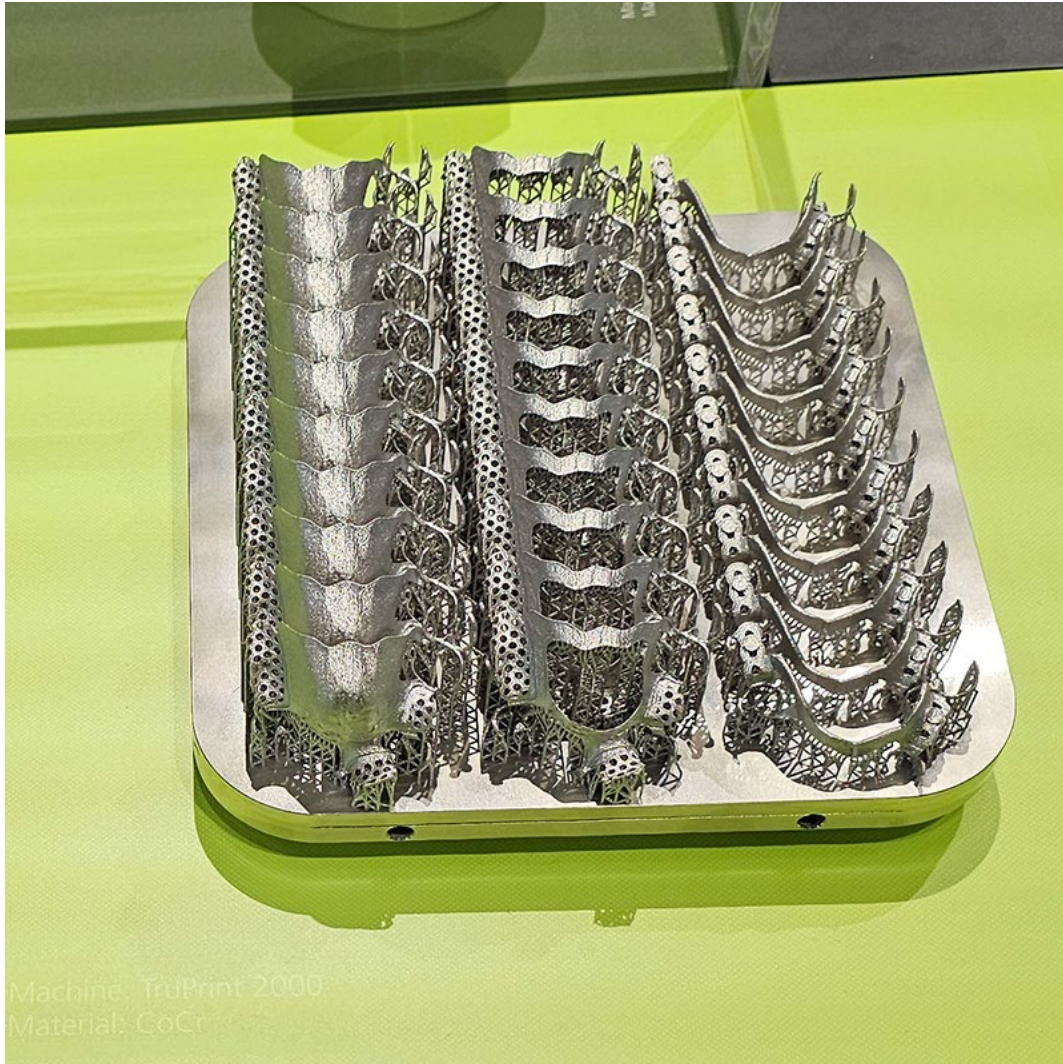
Removable partial dentures. Print time: 3h 54 min. Menetelmä: PBF, Materiaali: Ti64 ELI-A LMF. Valmistaja: Trumpf
