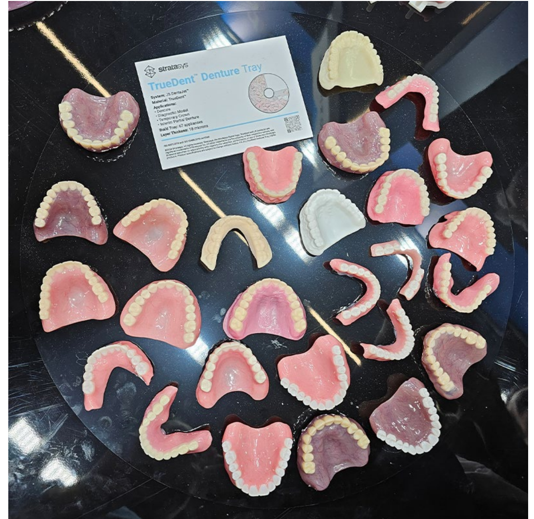
Truedent denture tray . Menetelmä: Polyjet (dental). Valmistaja: Stratasys
