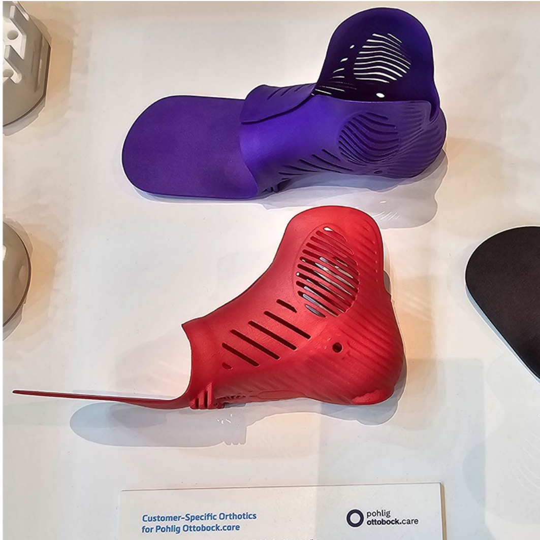
Customer-Specific orthotics. Menetelmä: SLS, Materiaali: PA12 Valmistaja: Pohlig ottobock.care / Materialise
