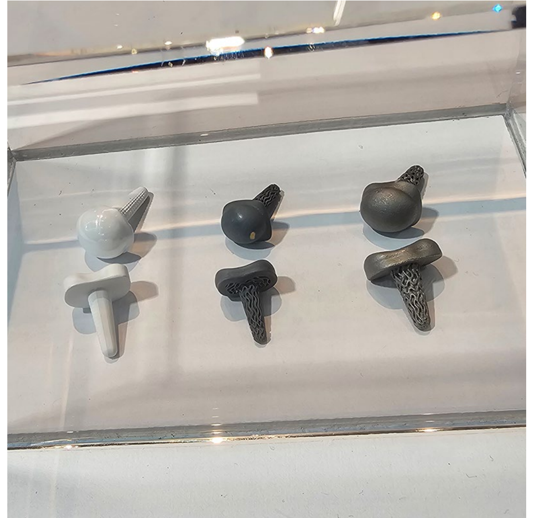
FingerKit-Demonstrator. Menetelmät: LPBF, CerAM VPP, Materiaalit: Ti, ZrO 2 , Si 3 N 4 , Valmistaja: Fraunhofer
