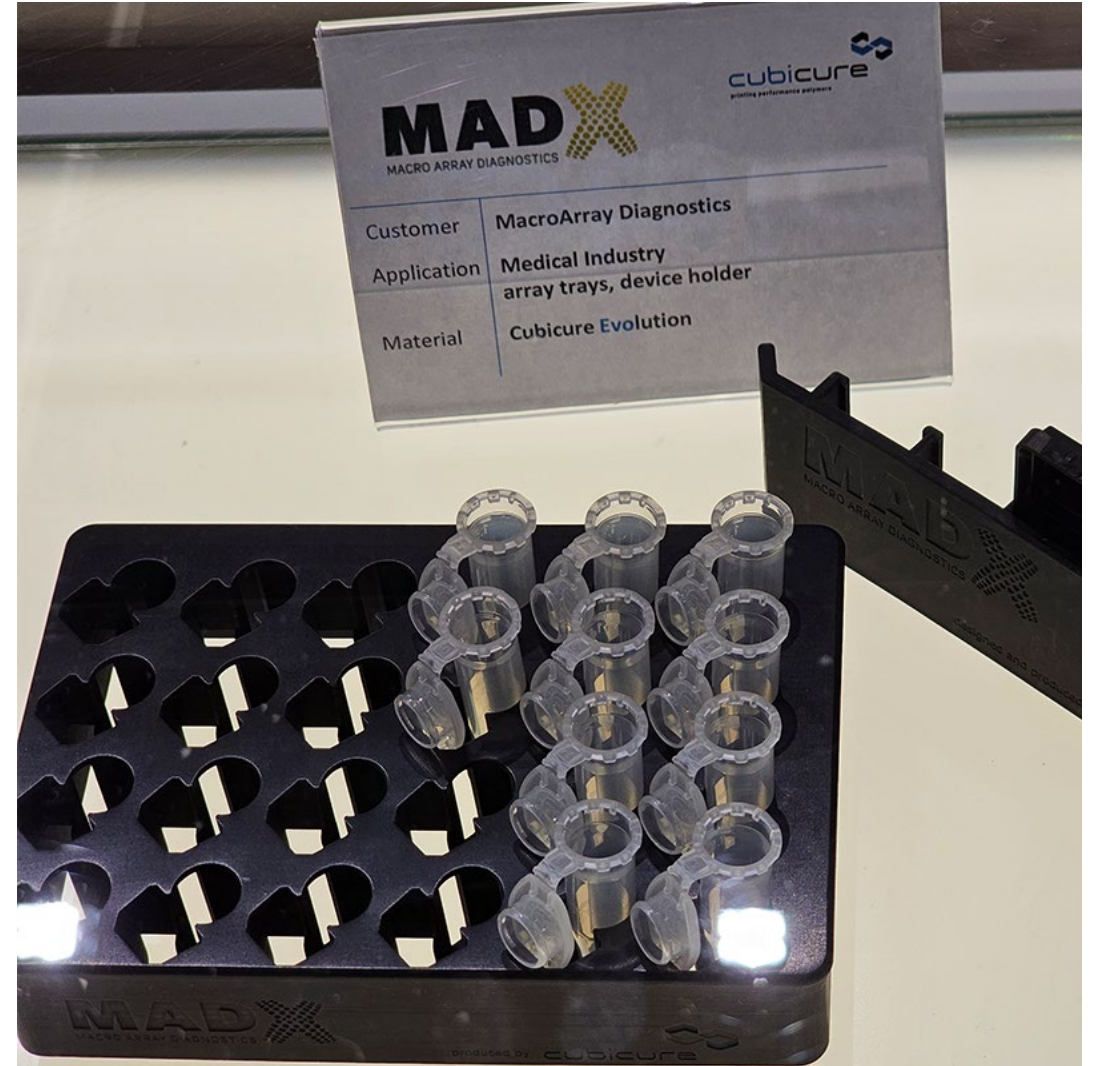
Medical Industry array trays. Menetelmä: Valokovetus, Materiaali: Cubicure evolution. Valmistaja: Macroarray diagnostics
