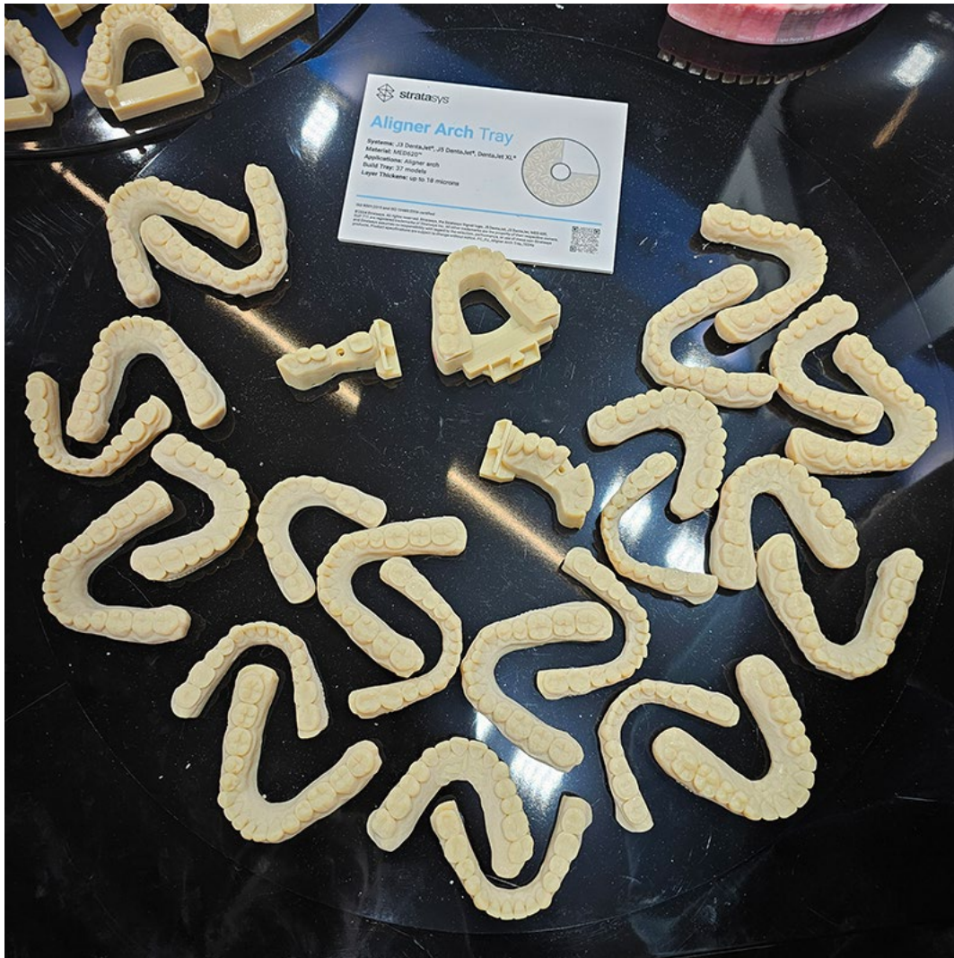
Aligner Arch Tray. Menetelmät: Polyjet (dental), Materiaali: MED620, Valmistaja: Stratasys
