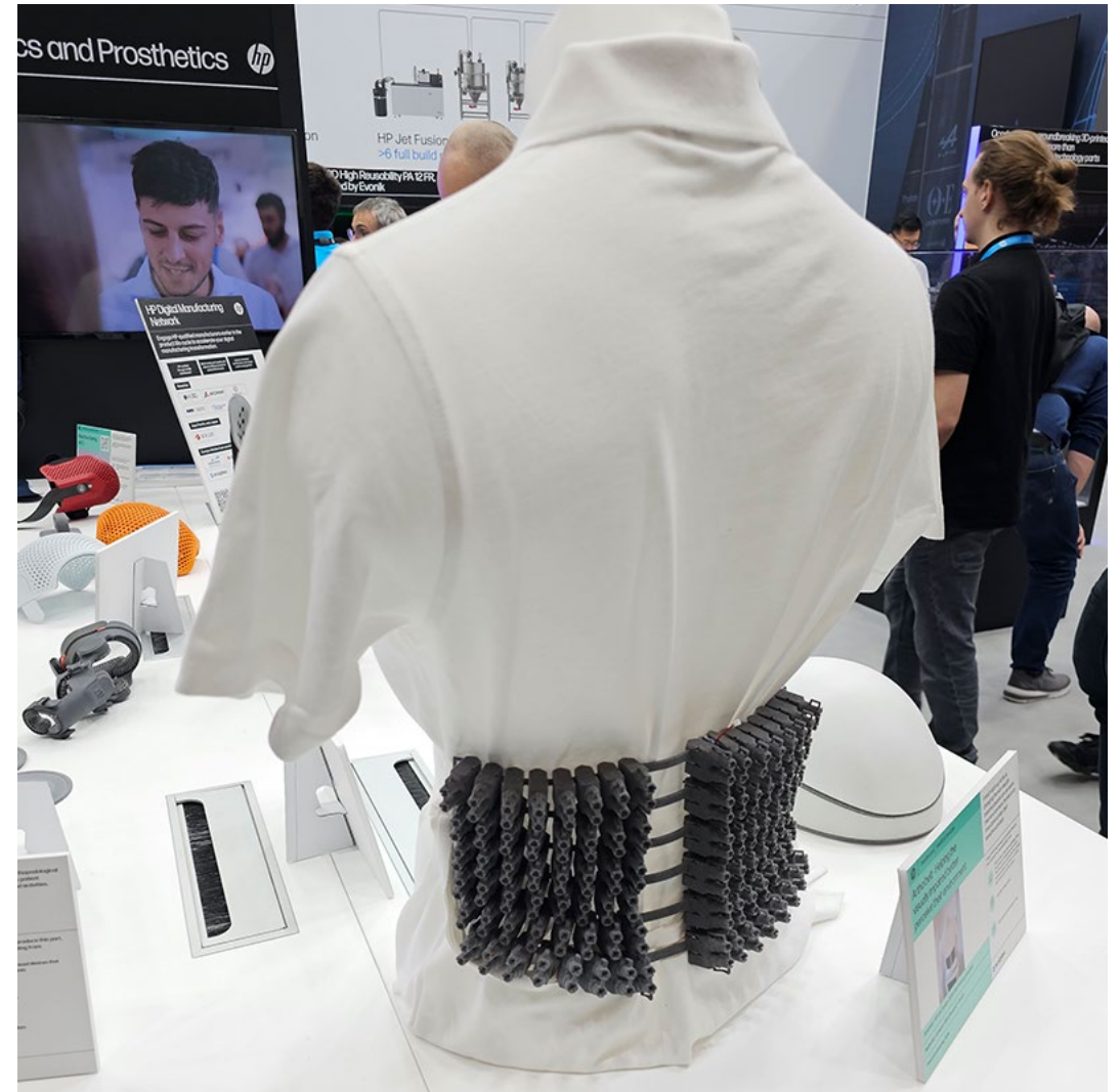
Artha belt. Menetelmä: HP MJF, Materiaali: Ultrasint TPU01, Valmistaja: Artha
