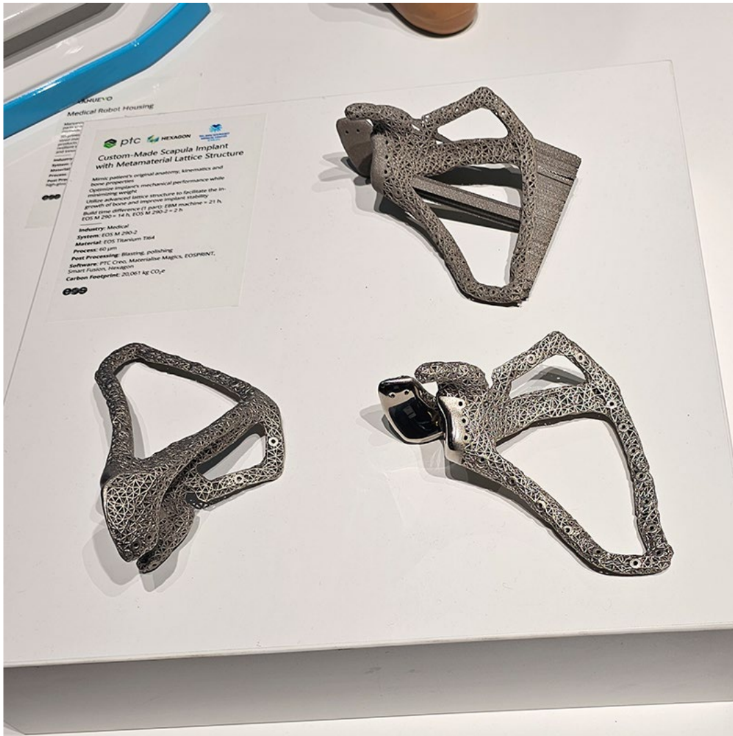
Custom-made scapula implant with metamaterial lattice structure. Menetelmä: PBF, Materiaali: Eos Ti64, Valmistaja: PTC, Hexagon, EOS
