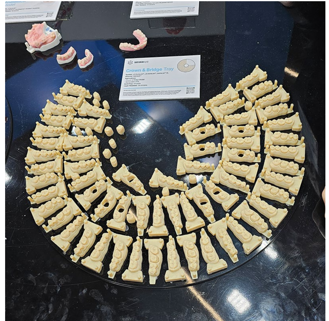
Crown & Bridge Tray. Menetelmä: Polyjet (Dental). Materiaali: MED620. Valmistaja: Stratasys
