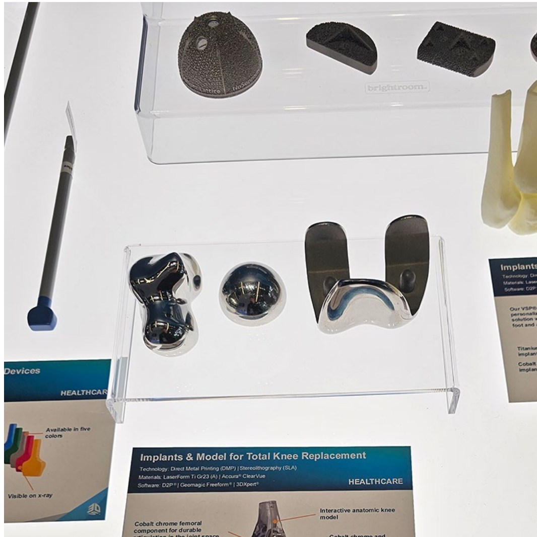
Implants for total knee replacement. Menetelmä: DMP, Materiaalit: Laserform Ti Gr23. Valmistaja: 3D Systems
