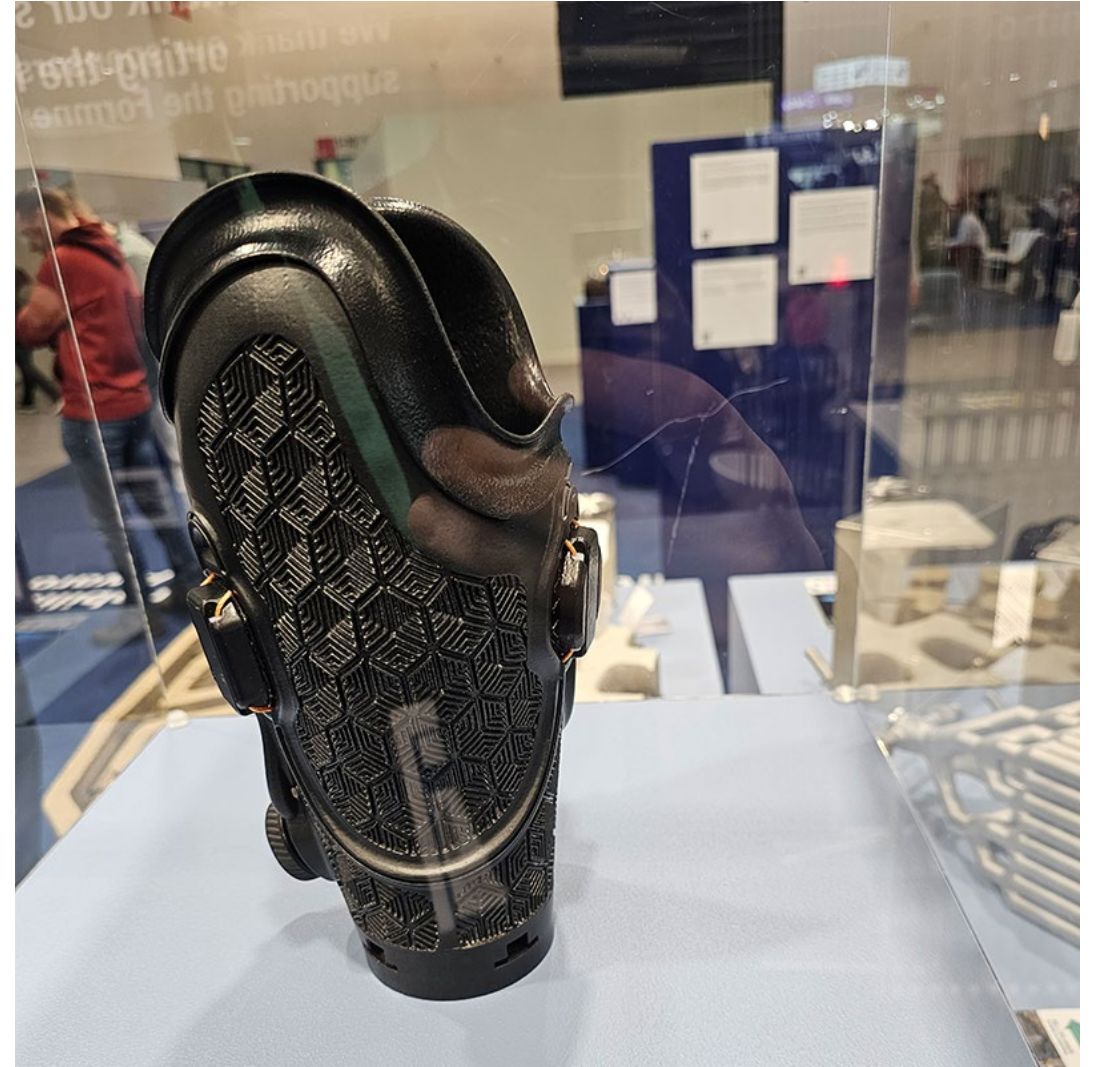
The Quatro - prosthesis socket. Menetelmä: HP MJF, Materiaali: PA12& TPA, Valmistaja: Quorum Orthopedics
