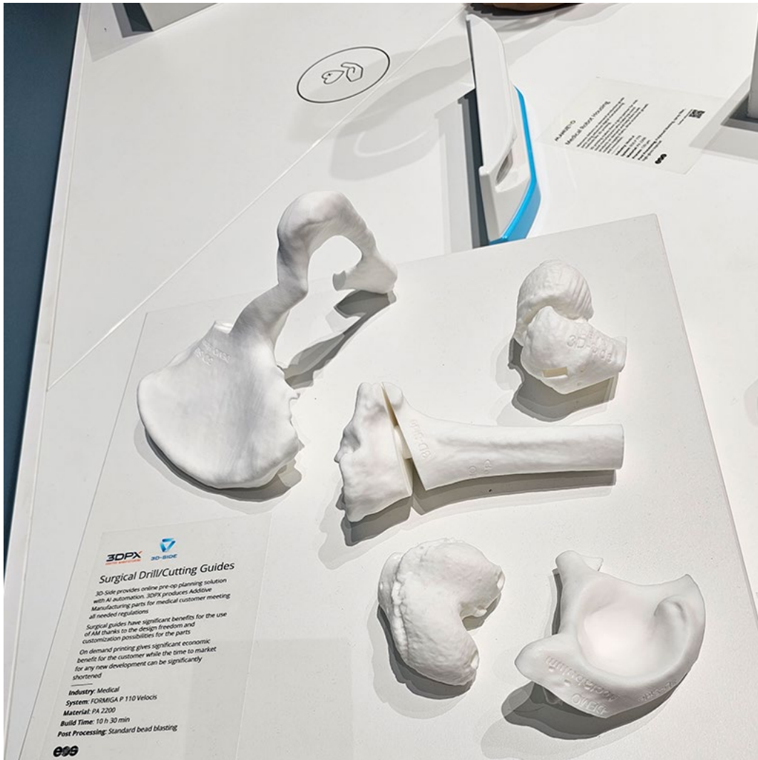
Surgical cutting guides. Menetelmä: SLS, Materiaali: PA2200. Valmistaja: 3DPX , 3D-side
