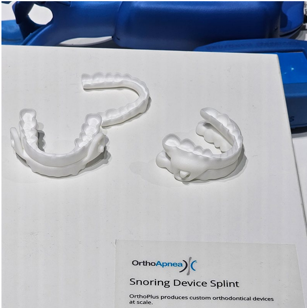
Snoring device splint. Menetelmä: SLS, Materiaalia: PA2200, Valmistaja: OrthoApnea / EOS
