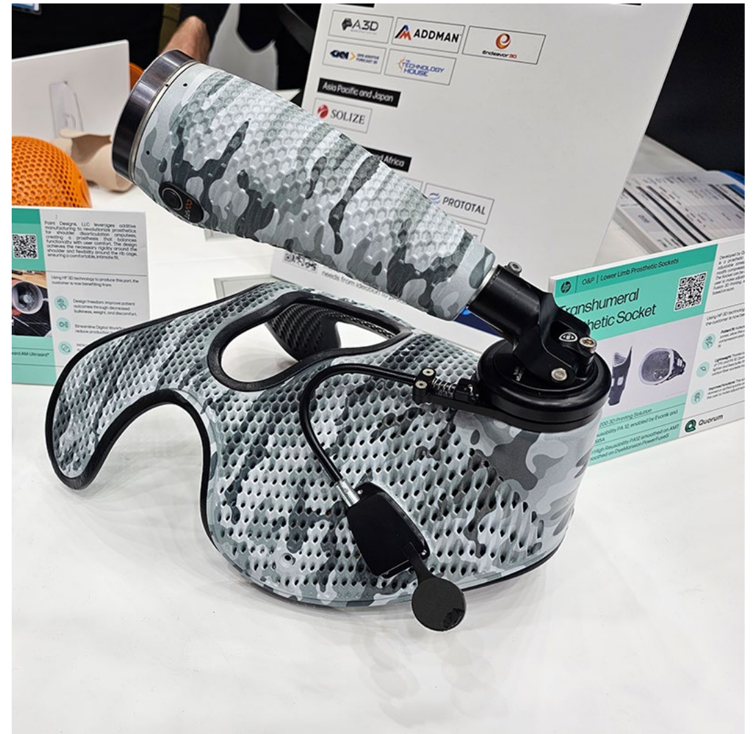
Shoulder prosthesis. Menetelmä: HP MJF, Materiaali: PA12, Ultrasint TPU01, PA12. Valmistaja: Point Designs LLC / HP
