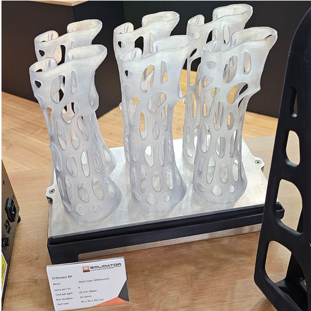
Orthoses 8K. Menetelmä: Valokovetus, Materiaali: R060 Clear, Valmistaja: Solidator
