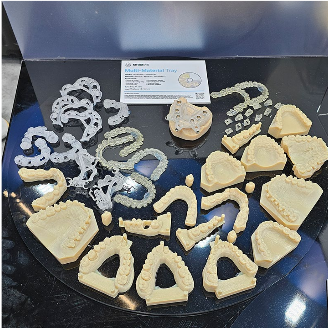
Surgical guide, denture try-in, custom tray, orthodontic model, prosthodontic model, gingiva mask, burnout pattern. Menetelmä: Polyjet (dental), Materiaalit: MED610, MED620, MED625FLX. Valmistaja: Stratasys
