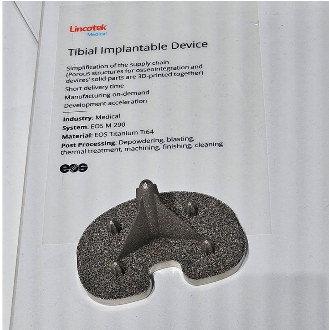
Tibial Implantable Device. Menetelmä: PBF, Materiaali: EOS Ti64, Valmistaja: Lincotek Medical / EOS
