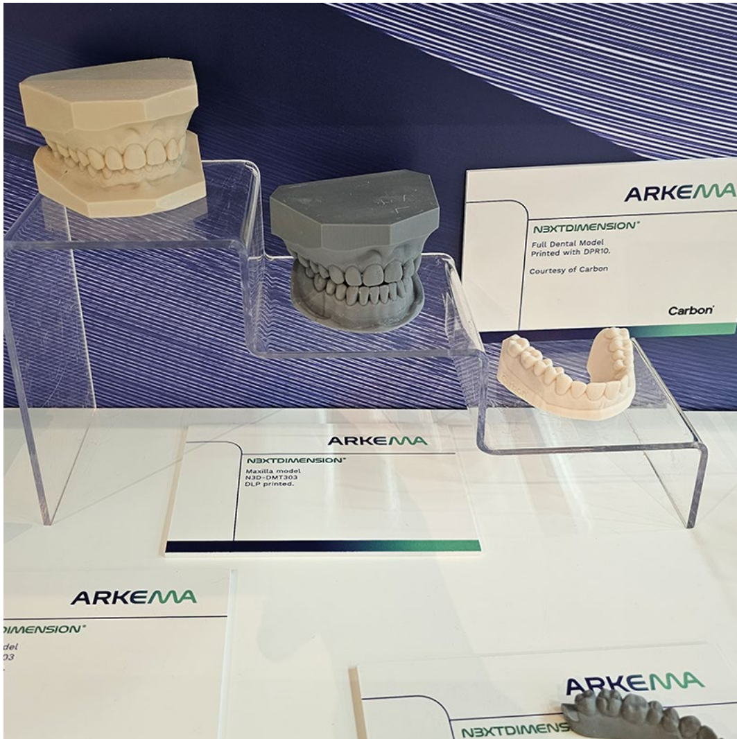
Dental models. Menetelmät: valokovetus (DLP) & Carbon DLS. Valmistaja: Arkema, Carbon3D
