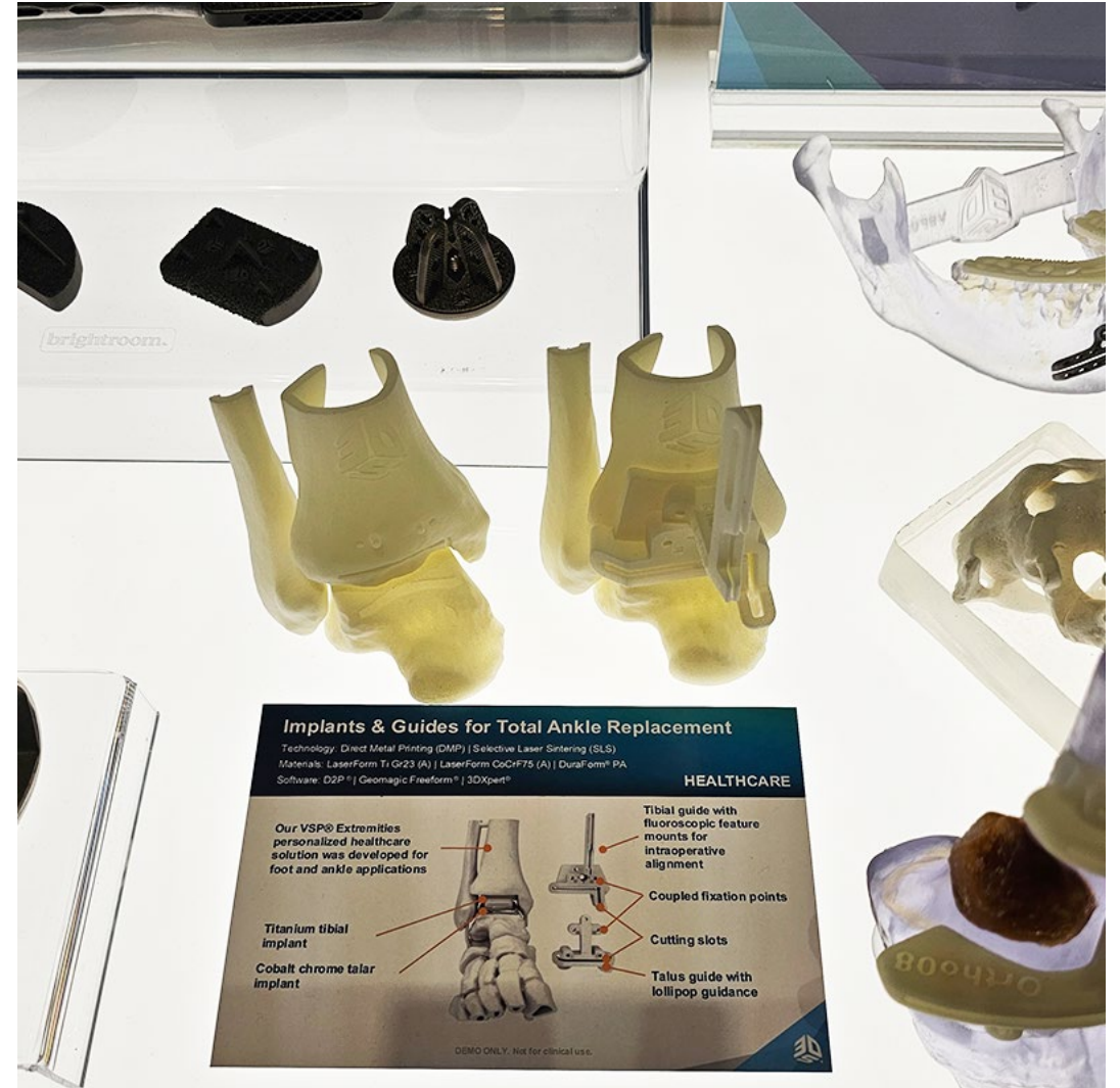
Implants for Total Ankle Replacement. Menetelmät: DMP, Materiaali: LaserForm Ti Gr23(A), LaserForm CoCr75 (A), Valmistaja: 3D Systems
