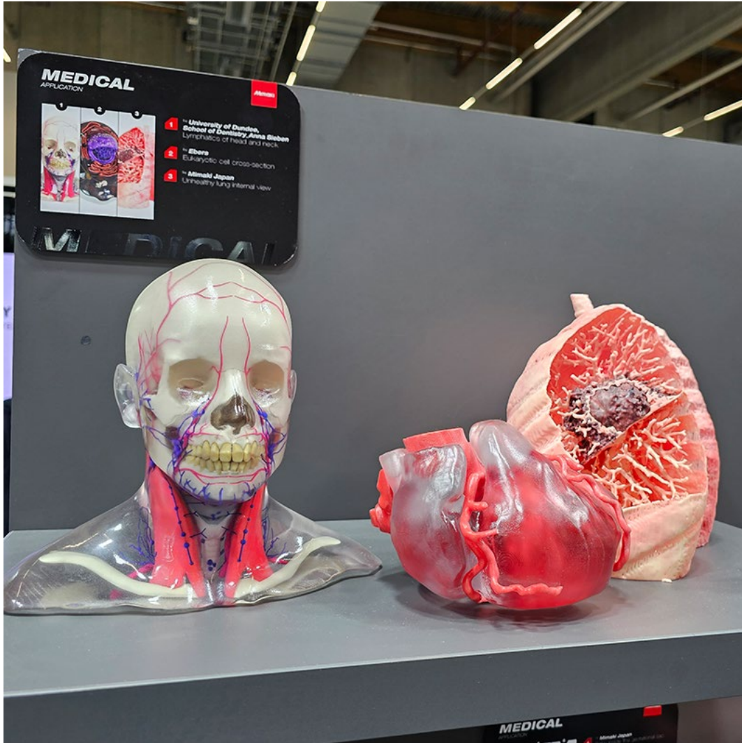
Anatomisia malleja. Menetelmä: Material jetting, Valmistaja: Mimaki
